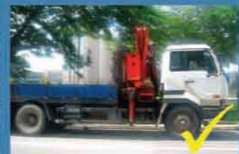
卡车起重机的吊臂完全收回
