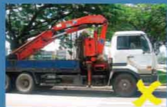
卡车起重机的吊臂只收回一部分
